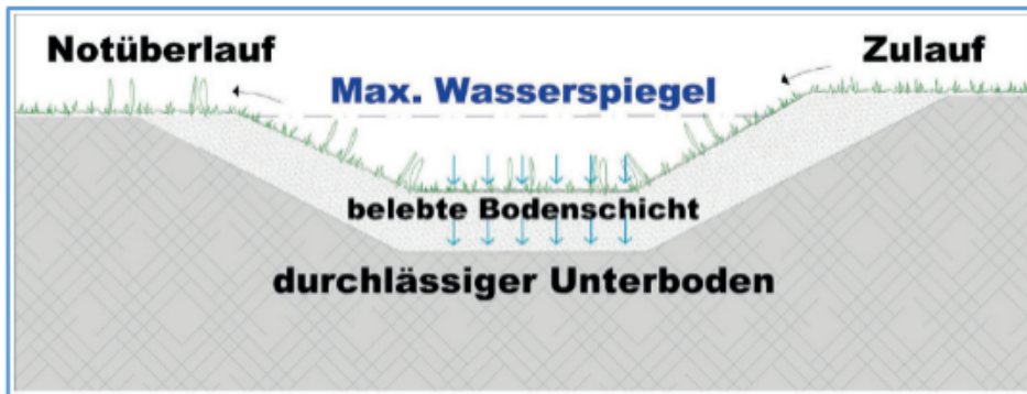
Abbildung: Skizze der Funktionsweise einer Versickerungsmulde (Quelle: KBOB)
